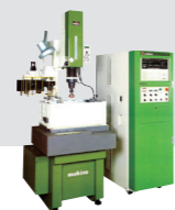
1980 NC形彫り放電加工機 EDNC22
